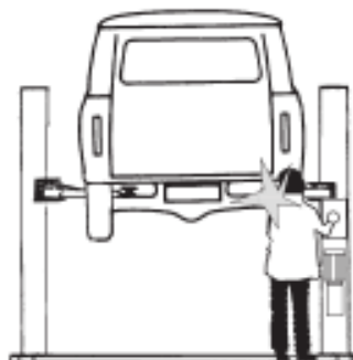
Рисунок 21. Риск обрушения на оператора
