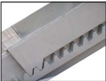
Предохранительное устройство главного подъемника
