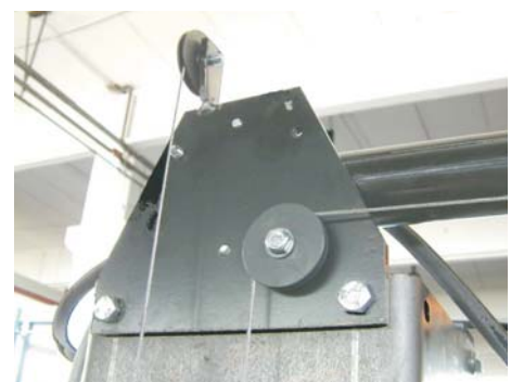
Fig.40b2 Passaggio cavo montante orizzontale colonna L.C. (2 carrucole) Passage cable horizontal upper rod C.S. Column (2 pulleys).
