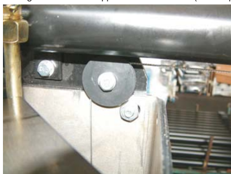
Fig.40b1 Passaggio cavo montante orizzontale colonna L.O. (1 carrucola). Passage cable horizontal upper rod O.S. Column (1 pulley).
