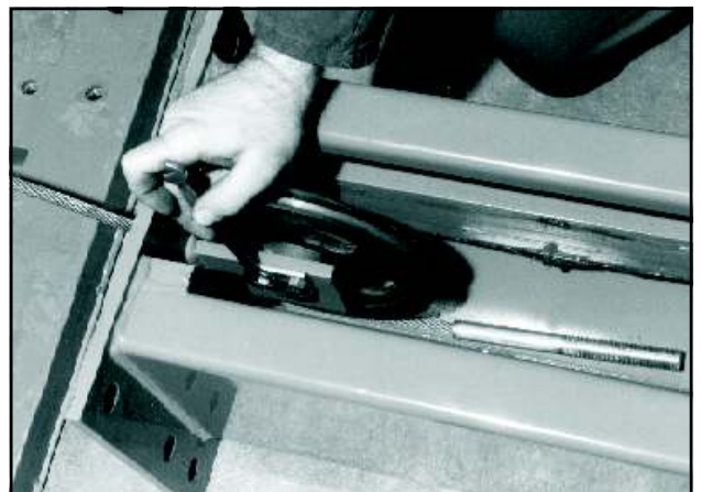
Fig.38 Smontaggio della puleggia Fig.38 Pulley demounting
